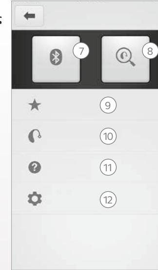
7. **Σύνδεση:** Εμφάνιση της κατάστασης μπαταρίας και σύνδεσης.
